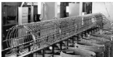
【アールシーサンコー社が製作する高架橋などの杭などに使用される鉄筋カゴ】
